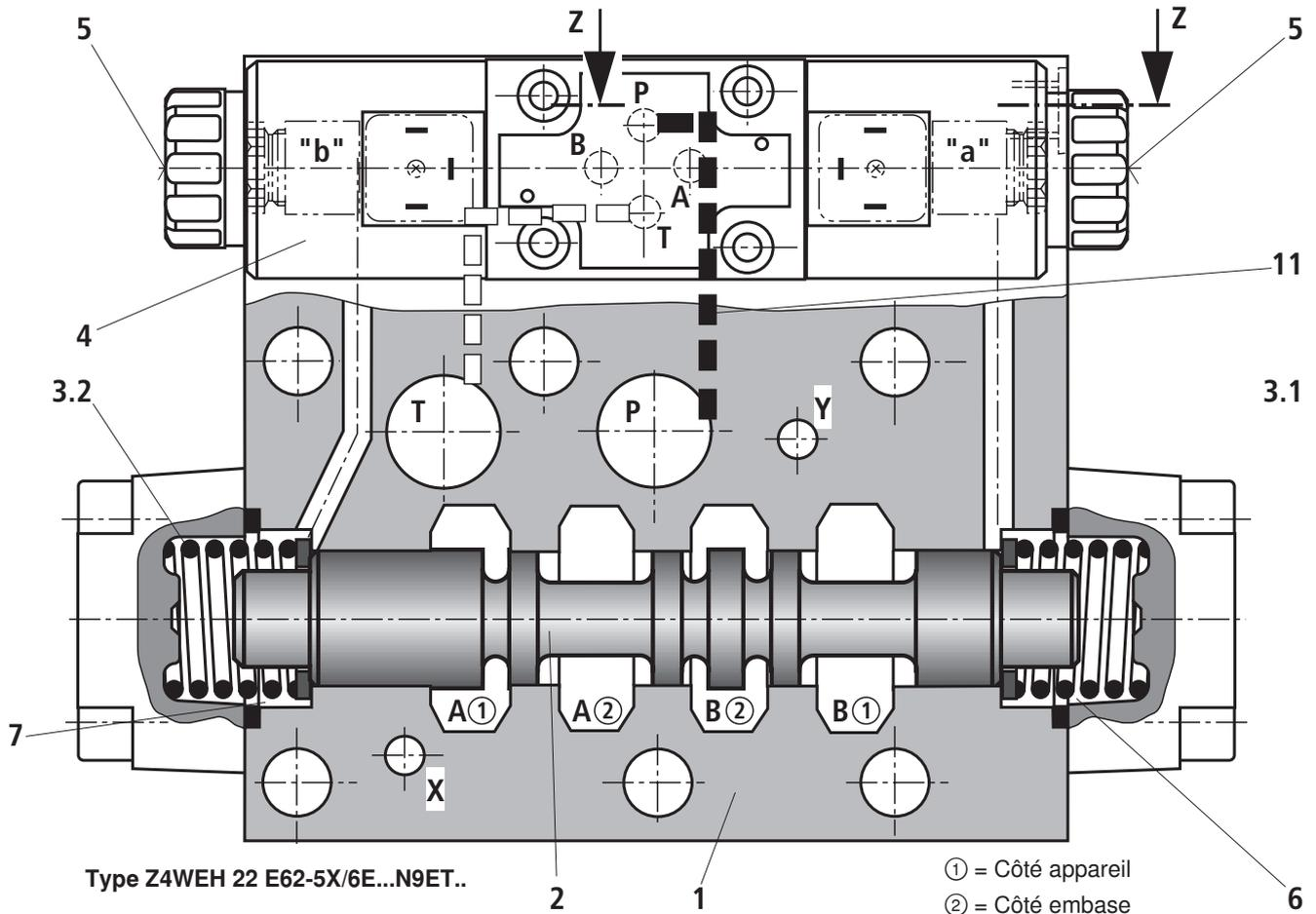
Le distributeur du type Z4WEH est un distributeur à tiroir à commande électrohydraulique. Il pilote le démarrage et l'arrêt et d'un débit.
