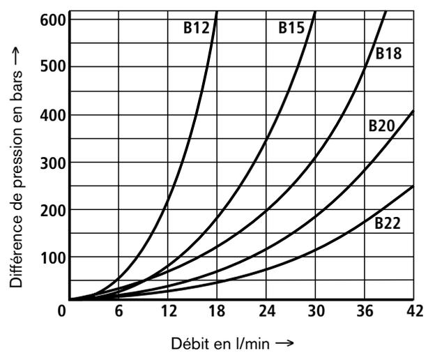
Seuil de puissance (mesuré avec HLP46,  $\vartheta_{\text{Huile}} = 40 \text{ °C} \pm 5 \text{ °C}$ )
