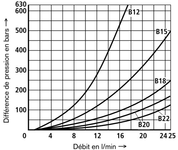
**Courbes caractéristiques: DN10 (mesurée avec HLP46,  $\vartheta_{\text{Huile}} = 40\text{ °C} \pm 5\text{ °C}$ )**
